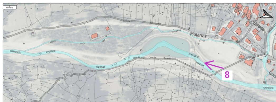
Figura 1.3: TRATTO 3 Intervento: Loc. Pattemouche, ricolmatura dell'alveo inciso con materiale proveniente dai disalvei a monte - indicazione della posizione e dell'orientamento delle fotografie riportate
